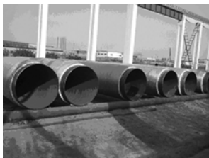
图 4 外护层固化中的聚氨酯保温管
