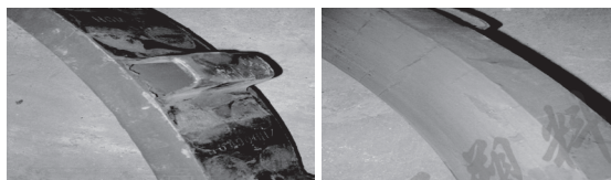
图4 14.9 MPa压缩强度的合成闸瓦使用后状态
