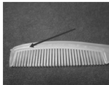
图 4 PP 塑料梳缩痕缺陷
