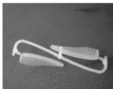
图 2 PP 塑料梳欠注缺陷
