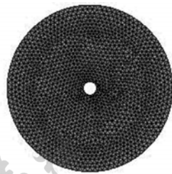
图1 圆形板有限元网格模型
