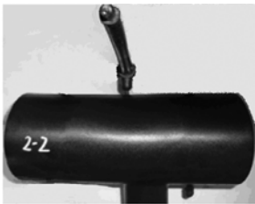
图11 实际注射成型的91.5°异径三通管件
