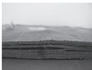
图4 乙烯基酯树脂/CBF复合材料着弹后的分层破坏和背面“鼓包”
