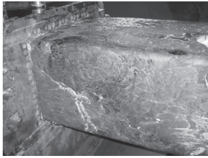
图 6 降低加工温度后轨枕表面状况
