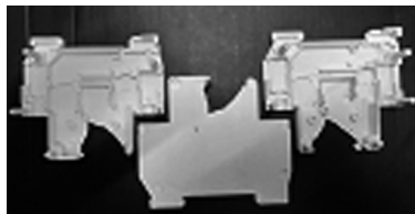
图9 50℃恒定模具温度时注塑出现的明显欠充
