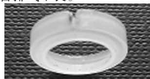
图3 模具排气不良造成的欠注产品
