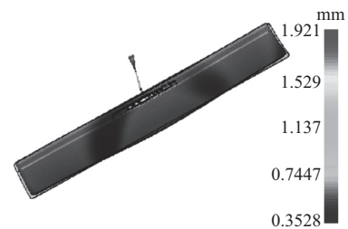
图6 优化工艺组合下塑料制品的收缩变形
