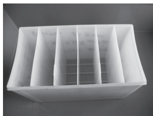
图3 无定型块时放置一周后蓄电池槽两端收缩变形情况
