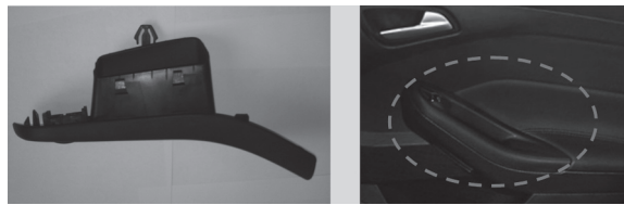
图 10 注塑成型的汽车门把手座及装车情况
