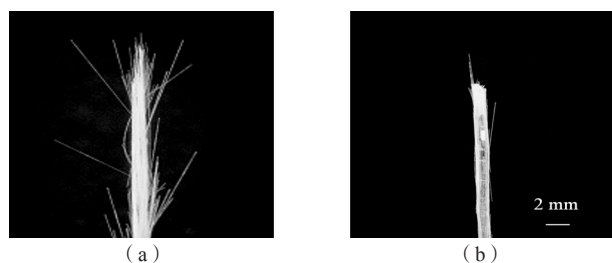
a—手工浸胶方式;b—直立式浸胶方式
