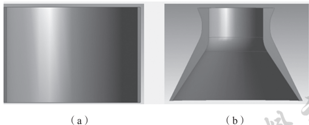
(a) (b) a—环形口模; b—锥形口模 图 1 口模的几何模型
