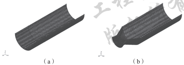
(a) (b) a—环形口模; b—锥形口模 图 2 计算域的网格划分
