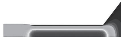
图8 L/D 为 4/1 时熔体轴线方向速度场分布
