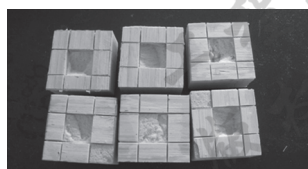
图 2 复合板材的表面胶合强度测试的破坏试样
