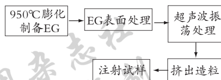
图1 复合材料制备工艺流程图
