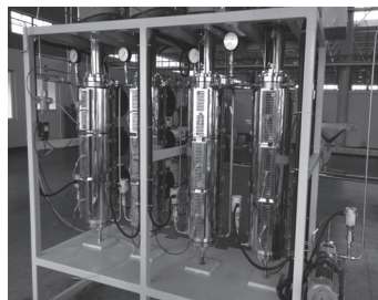
图 1 聚合反应装置图
