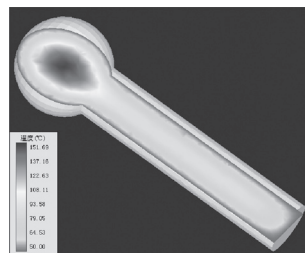
图 2 原宏观本构方程注射模拟温度分布图
