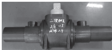
图 7 经静液压试验后合格的 PE 燃气阀门
