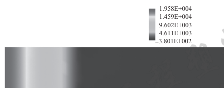
图7 气辅挤出条件下口模中心切面的熔体压力场
