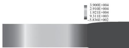
图6 普通挤出条件下口模中心切面的熔体压力场
