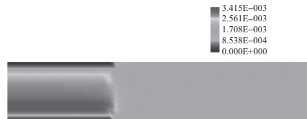
图5 气辅挤出条件下口模中心切面的熔体速度场
