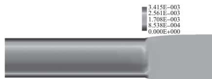
图4 普通挤出条件下口模中心切面的熔体速度场
