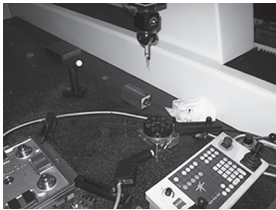
图 6 三坐标测量仪测量现场场景
