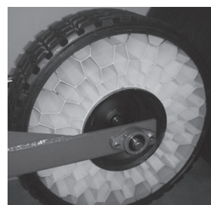
图1 蜂巢式塑料轮胎结构图
