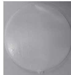
图 4 300 ^{\circ}\text{C} 时注塑的 PC 样板外观照片
