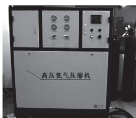
图6 高压氮气压缩机
