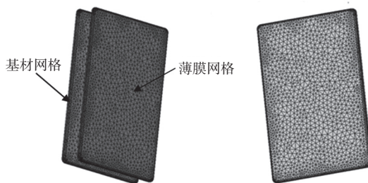
图 4 薄膜网格及其贴合至模型表面的状态
