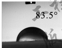
图 6 纯 PBS 的接触角照片
