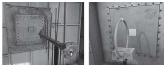
图8 屏蔽性能测试现场
