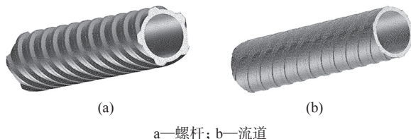
图 3 螺杆与流道有限元模型
