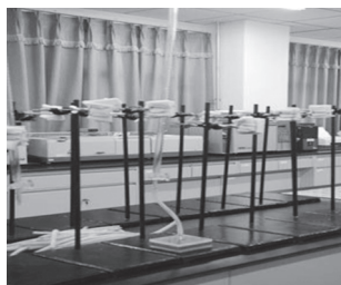
图5 植物纤维纸蜂窝芯材水迁移试验装置
