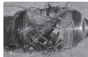
图9 \Phi 150 mm 标准复合材料压力容器破坏样貌图
