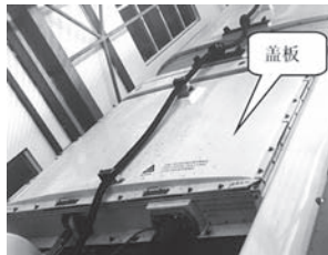
图 9 高压箱顶盖安装示意
