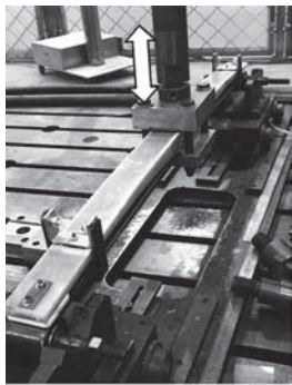
图 7 刚度及疲劳测试图
