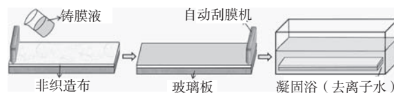
图1 PVC-C/PET复合膜的制备工艺
