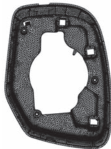
图2 后视镜外卡框网格模型
