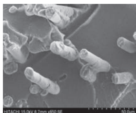
图5 添加偶联剂的20%玻纤增强PA6T/66复合材料SEM图
