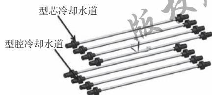
图 12 冷却水道结构形式
