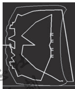
图5 碳纤维增强 EP 复合材料引擎盖切割路线图
