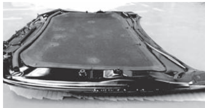
图 8 碳纤维增强 EP 复合材料引擎盖成品(背面)
