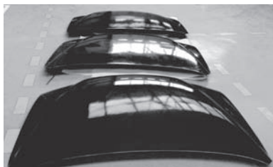
图9 碳纤维增强 EP 复合材料引擎盖成品(正面)
