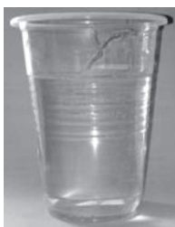
图 2 粉状 DDM 与双酚 A 型环氧树脂在 50^{\circ}\text{C} 搅拌 1 h 后的状态
