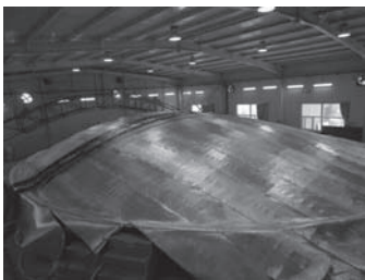
图10 主反射面电热膜固化工艺实施示意图
