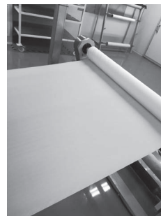
图 5 表面状态良好的半固化片收卷图
