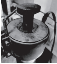
图2 石蜡聚集体作防护层时压制直观效果
