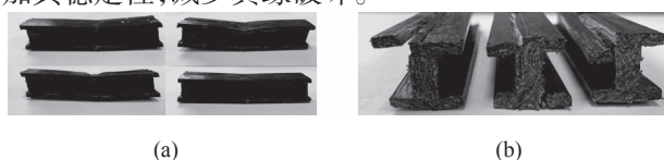
(a) a—腹板屈服; b—翼缘屈服 图 7 工字梁局部载荷下破坏形式
