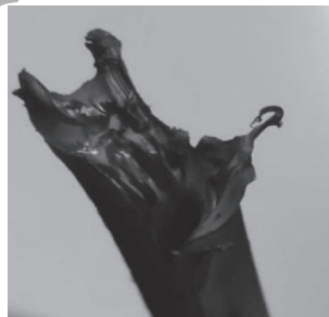
图12 B型拉伸试样断口形貌SEM照片
