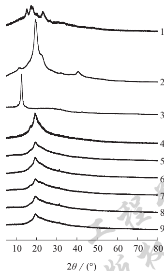
1—HACS; 2—PVAL; 3—GO; 4—HACS/PVAL; 5—添加 GO 质量分数 0.02% 的 HACS/PVAL/GO; 6—添加 GO 质量分数 0.04% 的 HACS/PVAL/GO; 7—添加 GO 质量分数 0.06% 的 HACS/PVAL/GO; 8—添加 GO 质量分数 0.08% 的 HACS/PVAL/GO; 9—添加 GO 质量分数 0.10% 的 HACS/PVAL/GO
