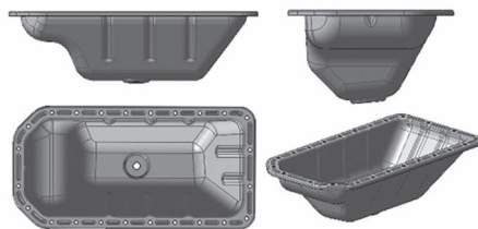
图4 钢制油底壳三视图与轴测视图
