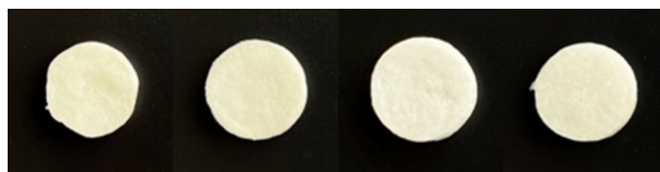
图2 不同col和CNF质量比时超轻气凝胶图片 (从左到右比例依次为,col:CNF=9:1,8:2,7:3,5:5)
