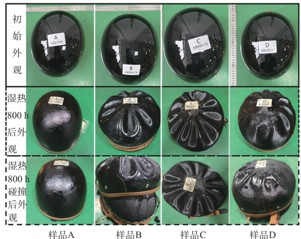
图7 湿热老化800h前后4种材质头盔样品形貌变化
