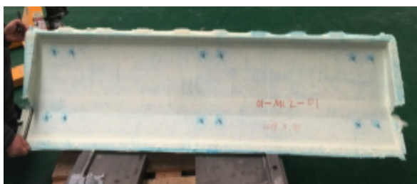
图5 袋压成型的蜂窝夹层结构裙板
