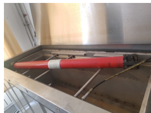
图7 管材GF带接头实验样品
